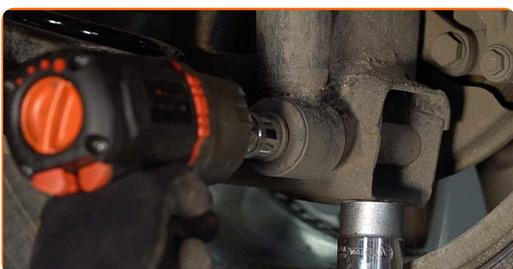
**20** Die Montage unter dem Hinterachsträger entfernen.
