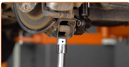
**22** Ziehen Sie den unteren Befestiger des Stoßdämpfers an. Verwenden Sie Stecknuss Nr. 19. Verwenden Sie einen Drehmomentschlüssel. Ziehen Sie ihn mit 110 Nm Drehmoment fest.
