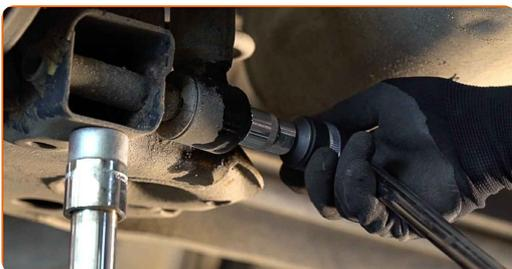
**12** Schrauben Sie das obere Befestigungselement des Stoßdämpfers ab.
