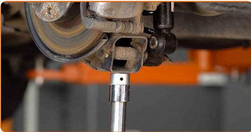
**14** Den Stoßdämpfer entfernen.
