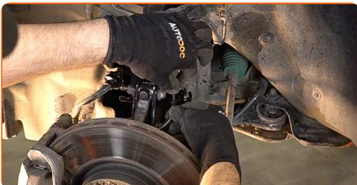
**45** Reinigen Sie die Oberfläche an welcher die Felge montiert werden soll. Benutzen Sie eine Drahtbürste. Behandeln Sie die Kontaktfläche. Benutzen Sie ein Kupferschmiermittel.
