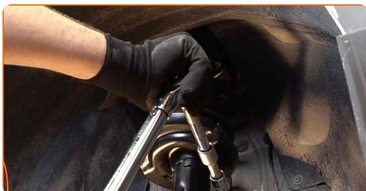
**43** Entfernen Sie den Träger unter dem Achsschenkel.
