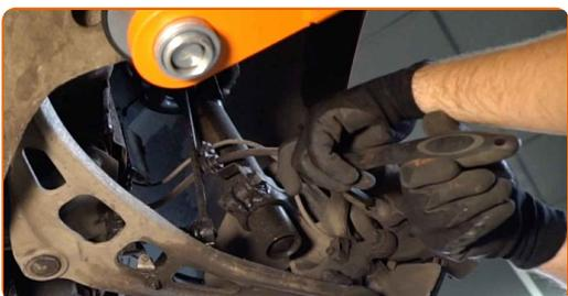
**10** Lösen Sie die Bremssattel-Haltefeder. Benutzen Sie ein Brecheisen.
