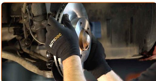
**21** Ziehen Sie die Befestigung der Bremsscheibe fest. Verwenden Sie den Torx T30. Verwenden Sie einen Drehmomentschlüssel. Ziehen Sie ihn mit 16 Nm Drehmoment fest.
