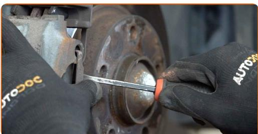
**11** Entfernen Sie den Bremssattel.
