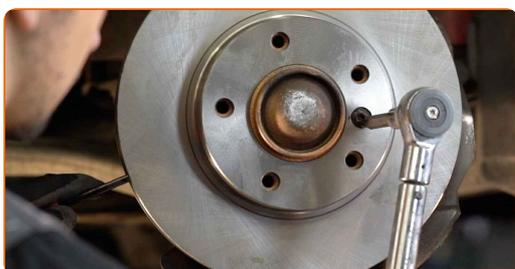
**22** Setzen Sie die Halterung des Bremssattels ein.
