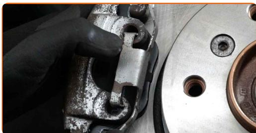
**21** Ziehen Sie die Bremssattelbefestigungen fest. Verwenden Sie Inbusschlüssel Nr. H7. Verwenden Sie einen Drehmomentschlüssel. Ziehen Sie ihn mit 30 Nm Drehmoment fest.
