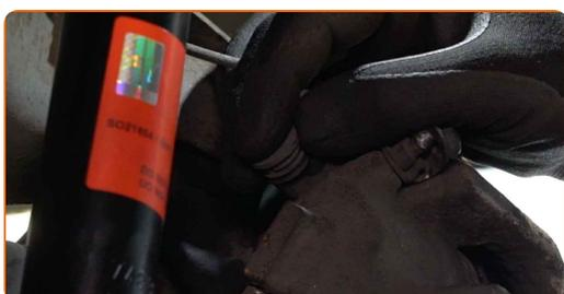
**23** Bauen Sie den Verschleißsensor auf den Bremsbelägen ein. Verwenden Sie eine Rundzange.
