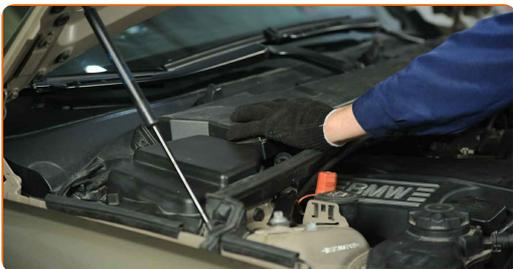
**53** Schrauben Sie die Verbindungselemente der Innenfilter-Gehäuseabdeckung ein. Verwenden Sie Stecknuss Nr. 8. Verwenden Sie einen Ratschenschlüssel.
