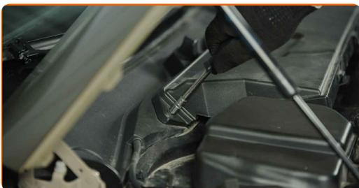
**54** Entfernen Sie die Kotflügel-Abdeckung.
