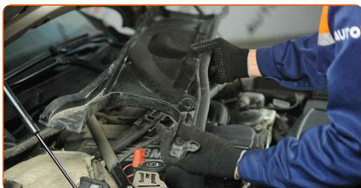
**14** Schrauben Sie die Befestigung der diagonalen Streben auf. Verwenden Sie Stecknuss Nr. E14. Verwenden Sie einen Ratschenschlüssel.
