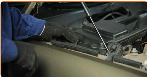
**50** Bringen Sie die Windlaufabdeckung an, die sich an der linken Seite befindet und sichern Sie sie.
