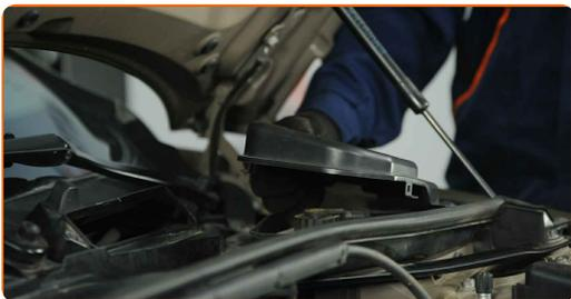
**51** Bringen Sie die Befestigungselemente der Windlaufabdeckung an.
