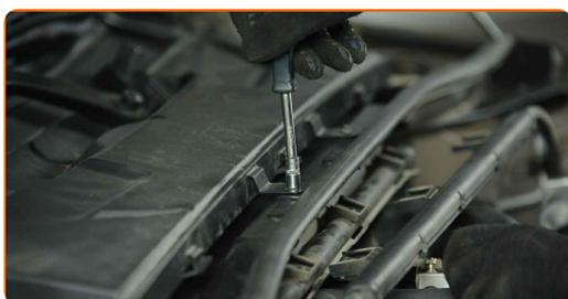
**11** Entfernen Sie den Gehäusedeckel des Innenraumfilters.
