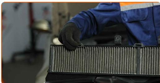
**6** Entfernen Sie das Filterelement aus dem Filtergehäuse.
