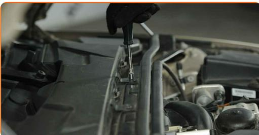
**4** Entfernen Sie den Gehäusedeckel des Innenraumfilters.
