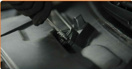
**3.2** Verwenden Sie Stecknuss Nr. 8. Verwenden Sie einen Ratschenschlüssel.
