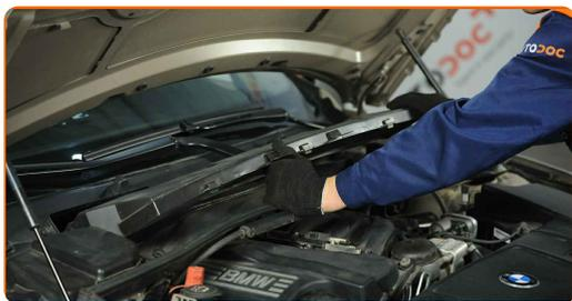
**5** Lösen Sie die Clips der Innenraumfilterabdeckung.
