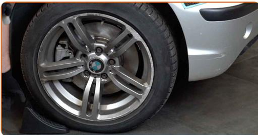
**4** Lösen Sie die Radhalterungsschrauben. Verwenden Sie eine Schlagnuss für Felgen # 17.
