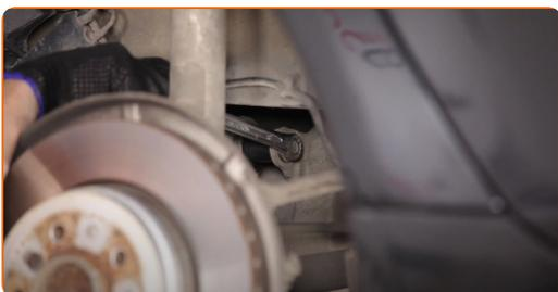
**23** Entfernen Sie den Träger unter der Achsschenkelachse.
