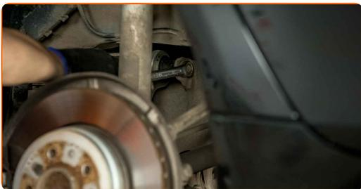
**21** Stützen Sie die Achsschenkelachse auf. Benutzen Sie einen hydraulischen Getriebeheber.
