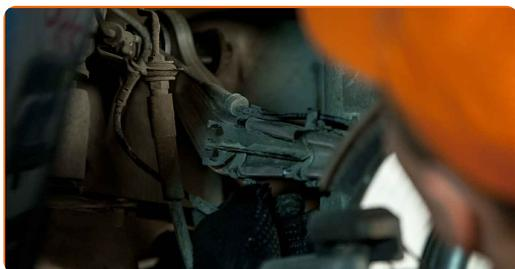
**25** Verbinden Sie das Bremsbelagverschleißkabel.
