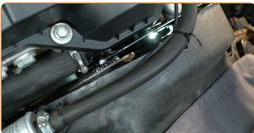
**4** Entfernen Sie die Gummileiste der Lüfterzarge.
