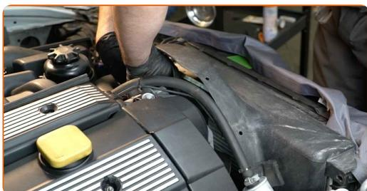
**21** Ziehen Sie die Befestigung der Viskokupplung fest. Verwenden Sie Ring-Gabelschlüssel Nr. 32. Verwenden Sie einen Drehmomentschlüssel. Ziehen Sie ihn mit 40 Nm Drehmoment fest.
