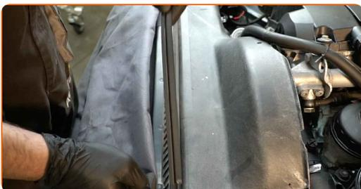
**5** Schrauben Sie die Viskokupplung aus und entfernen Sie sie.
