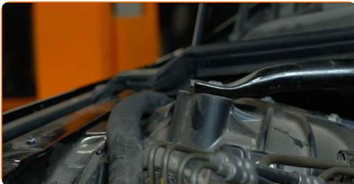
**5** Lösen Sie die Clips der Innenraumfilterabdeckung.
