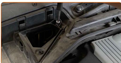
**15** Entfernen Sie den unteren Teil des Innenraumfiltergehäuses.
