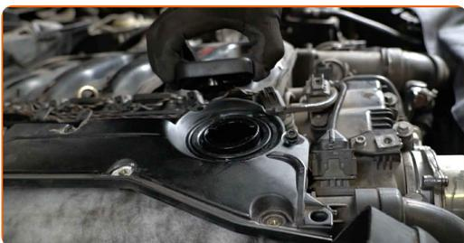
**27** Entfernen Sie die Öleinfüllschraube.
