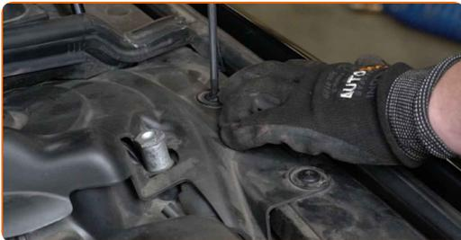
**4** Entfernen Sie die Schutzkappen aus dem Fixierungsbügel des Stoßdämpfers.
