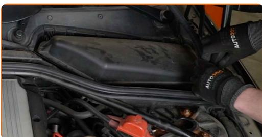
**11** Entfernen Sie den Gehäusedeckel des Innenraumfilters.
