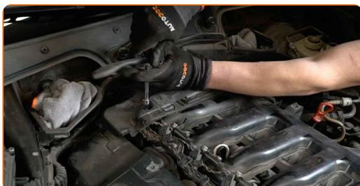
**25** Entfernen Sie den hinteren Teil der Motorabdeckung.
