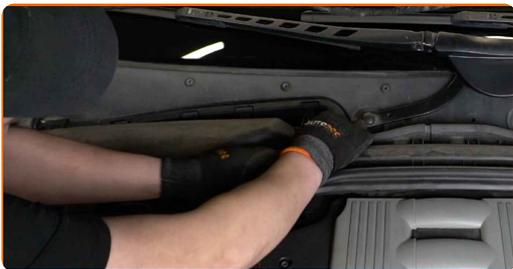
**6** Schrauben Sie die Verbindungselemente der Innenfilter-Gehäuseabdeckung ab. Verwenden Sie Stecknuss Nr. 13. Verwenden Sie einen Ratschenschlüssel.
