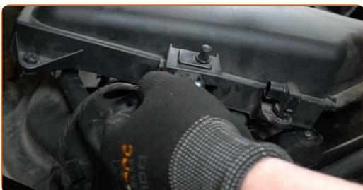
**13** Entfernen Sie die Abdichtung des Mikrofilterkastens.
