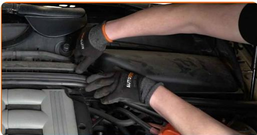
**10** Schrauben Sie die Verbindungselemente der Innenfilter-Gehäuseabdeckung ab. Verwenden Sie Stecknuss Nr. 13. Verwenden Sie einen Ratschenschlüssel.
