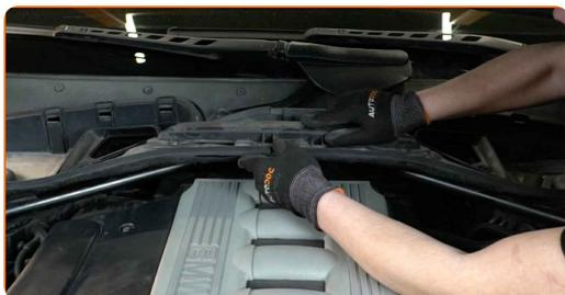
**48** Schrauben Sie die Befestigungen des unteren Teils des Innenraumfiltergehäuses ein. Verwenden Sie Stecknuss Nr. 13. Verwenden Sie einen Ratschenschlüssel.
