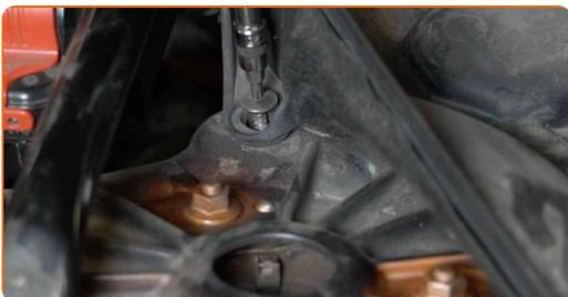
**8** Entfernen Sie den Gehäusedeckel des Innenraumfilters.
