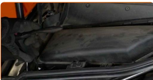
**7** Schrauben Sie die Befestigungen des unteren Teils des Innenraumfiltergehäuses ab. Verwenden Sie den Torx T25. Verwenden Sie einen Ratschenschlüssel.
