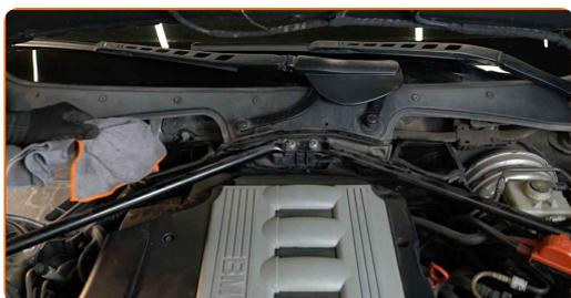
**47** Setzen Sie den unteren Teil des Innenraumfiltergehäuses wieder ein.
