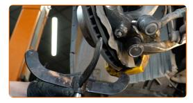
21 Entfernen Sie die Befestigungsschraube.
