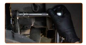
Schrauben Sie die Befestigung der Pendelstützenhalterung fest. Verwenden Sie Stecknuss Nr. 16. Verwenden Sie einen Drehmomentschlüssel. Ziehen Sie ihn mit 65 Nm Drehmoment fest.
