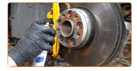
Die Bremsscheibenoberfläche reinigen. Benutzen Sie einen Bremsenreiniger.
