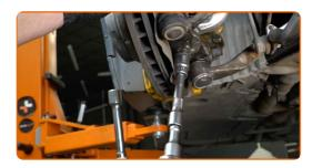
Ziehen Sie die Befestigungsmutter an, die den Spurstangenkopf mit dem Achsschenkel verbindet. Verwenden Sie Stecknuss Nr. 21. Verwenden Sie einen Drehmomentschlüssel. Ziehen Sie ihn mit 165 Nm Drehmoment fest.
