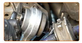
Entfernen Sie den Träger unter dem Achsschenkel.
