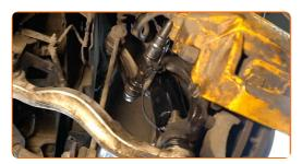
Schrauben Sie die Befestigungen des Sensors der Leuchtweitenregulierung fest. Verwenden Sie Stecknuss Nr. 10. Verwenden Sie einen Drehmomentschlüssel. Ziehen Sie ihn mit 7 Nm Drehmoment fest.
