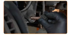
Schrauben Sie die Befestigung der Pendelstützenhalterung ab. Verwenden Sie Stecknuss Nr. 16. Verwenden Sie einen Ratschenschlüssel.
