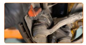
Lösen Sie das Ende der Befestigungsmutter an dem Achsschenkel. Verwenden Sie Stecknuss Nr. 21. Verwenden Sie einen Ratschenschlüssel.
