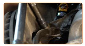
Ziehen Sie die unteren Befestigungen an, die das Federbein mit dem Achsschenkel verbinden. Verwenden Sie Stecknuss Nr. 18. Verwenden Sie einen Drehmomentschlüssel. Ziehen Sie ihn mit 81 Nm Drehmoment fest.
