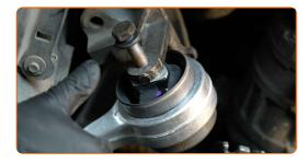
37 Schrauben Sie die vordere Armbefestigung an. Verwenden Sie Ring-Gabelschlüssel Nr. 18.
