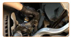
Schließen Sie den Sensor der Leuchtweitenregulierung wieder an.
