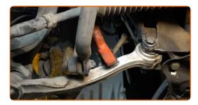
Schrauben Sie die Befestigungen des Sensors der Leuchtweitenregulierung ab. Verwenden Sie Ring-Gabelschlüssel Nr. 9. Verwenden Sie Ring-Gabelschlüssel Nr. 10.
