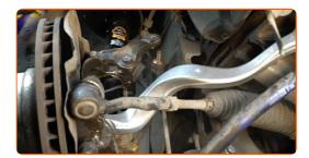
Ziehen Sie die Befestigungselemente des Stabilenkers fest. Verwenden Sie Ring-Gabelschlüssel Nr. 16.
