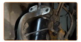
Schrauben Sie die Befestigung der Pendelstützenhalterung ein. Verwenden Sie Stecknuss Nr. 16. Verwenden Sie einen Ratschenschlüssel.
