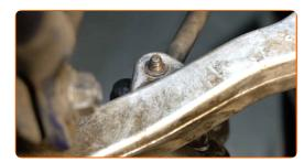
Schrauben Sie die Befestigungen des Sensors der Leuchtweitenregulierung ein. Verwenden Sie Ring-Gabelschlüssel Nr. 9. Verwenden Sie Ring-Gabelschlüssel Nr. 10.
