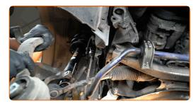
Reinigen Sie die Montagebohrungen und die Gewinde des Querlenkers. Benutzen Sie eine Drahtbürste. Benutzen Sie WD-40-Spray.
