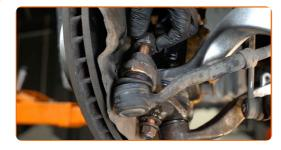
Schrauben Sie die Befestigungsmutter auf, die den Spurstangenkopf mit dem Achsschenkel verbindet. Verwenden Sie Stecknuss Nr. 21. Verwenden Sie einen Ratschenschlüssel.
