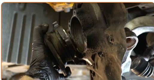
**35** Reinigen Sie den Einbauort für die Nabenlagerung. Benutzen Sie eine Drahtbürste. Verwenden Sie Allzweckreinigungsspray.
