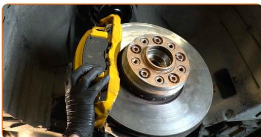
**51** Befestigen Sie die Bremssattelhalterung. Verwenden Sie Stecknuss Nr. 18. Verwenden Sie einen Drehmomentschlüssel. Ziehen Sie ihn mit 110 Nm Drehmoment fest.
