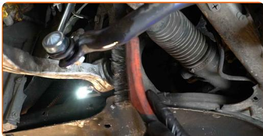
**21** Schrauben Sie die Befestigungen des Sensors der Leuchtweitenregulierung ab. Verwenden Sie Stecknuss Nr. 10. Verwenden Sie einen Ratschenschlüssel.
