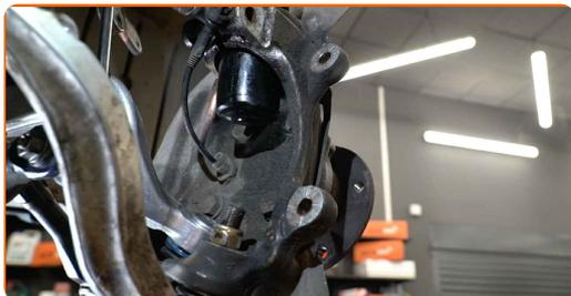
**28** Reinigen Sie das Befestigungselement der Radnabe. Benutzen Sie eine Drahtbürste. Benutzen Sie WD-40-Spray.
