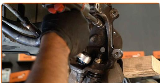
**34** Entfernen Sie die Nabe und das Lager zusammen, da sie eine versiegelte Einheit sind.
