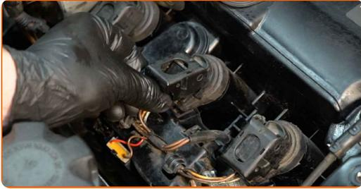
**14** Behandeln Sie den Zündspulenanschluss mit einem Elektronikspray. Das Spray wird die elektrischen Kontakte vor Korrosion und Oxidation schützen und den Kontaktwiderstand reduzieren.
