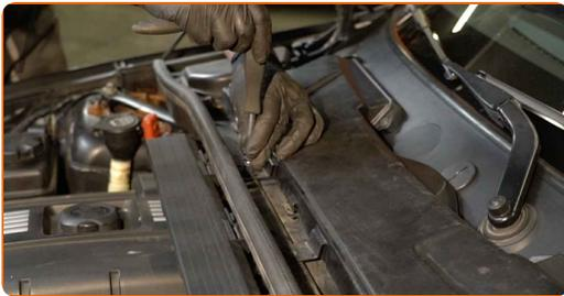
**4** Entfernen Sie den Gehäusedeckel des Innenraumfilters.
