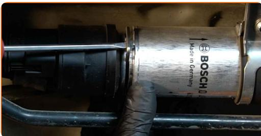
**4** Lockern Sie die Befestigungsklemme der Kraftstofffilterleitung. Verwenden Sie einen flachen Schraubendreher.
