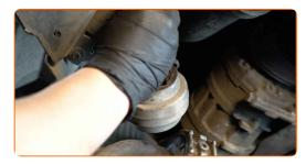
Schrauben Sie die vordere Armbefestigung an. Verwenden Sie Ring-Gabelschlüssel Nr. 18. Verwenden Sie Stecknuss Nr. 18. Verwenden Sie einen Ratschenschlüssel.
