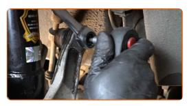
Verbinden Sie das ABS mit der Sensorverdrahtung.
