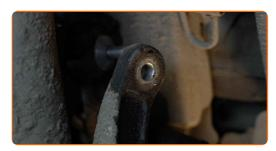
Schrauben Sie die Befestigung der Pendelstützenhalterung ab. Verwenden Sie Stecknuss Nr. 16. Verwenden Sie einen Ratschenschlüssel.
