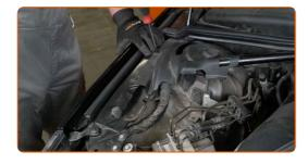
Entfernen Sie die Schutzkappe von der Stoßdämpferstütze.
