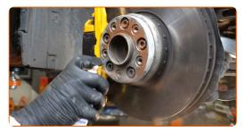
Die Bremsscheibenoberfläche reinigen. Benutzen Sie einen Bremsenreiniger.
