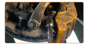
Ziehen Sie das vordere Befestigungselement an, das den Querlenker mit dem Hilfsrahmen verbindet. Verwenden Sie Ring-Gabelschlüssel Nr. 18. Verwenden Sie Stecknuss Nr. 18. Verwenden Sie einen Drehmomentschlüssel. Ziehen Sie ihn mit 100 Nm Drehmoment fest.+90°
