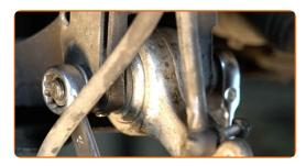
77 Entfernen Sie den Träger unter dem Achsschenkel.
