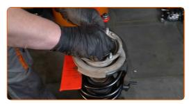
Ziehen Sie die Federbeinkolbenstangenmutter an. Verwenden Sie Stecknuss Nr. 22. Verwenden Sie Inbusschlüssel Nr. H6. Verwenden Sie einen Drehmomentschlüssel. Ziehen Sie ihn mit 64 Nm Drehmoment fest.
