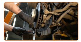
Lösen Sie die hintere Befestigung des Querlenkers. Verwenden Sie Ring-Gabelschlüssel Nr. 18.
