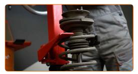
Entfernen Sie die Kappe des Federbeinstützlagers. Benutzen Sie ein Brecheisen.
