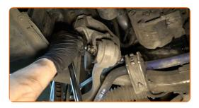
Trennen Sie die ABS Sensorverdrahtung.
