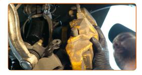
Befestigen Sie die Bremssattelhalterung. Verwenden Sie Stecknuss Nr. 18. Verwenden Sie einen Drehmomentschlüssel. Ziehen Sie ihn mit 110 Nm Drehmoment fest.
