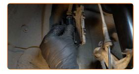
Schließen Sie den Sensor der Leuchtweitenregulierung wieder an.
