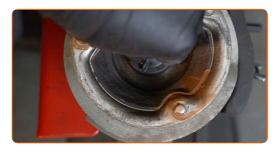
Dekomprimieren Sie die Feder.
