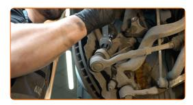
Ziehen Sie den Spurstangenkopf vom Achsschenkel. Verwenden Sie einen Kugelgelenkabzieher.
