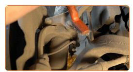
Schrauben Sie das Befestigungselement heraus, das die Druckstange mit dem Federbein verbindet. Verwenden Sie Ring-Gabelschlüssel Nr. 16. Verwenden Sie den Torx T30. Verwenden Sie einen Ratschenschlüssel.
