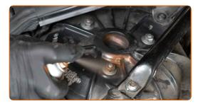
Setzen Sie die Schutzkappe auf die Stoßdämpferstütze.
