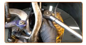
Befestigen Sie den Bremsschlauch an der Strebe.
