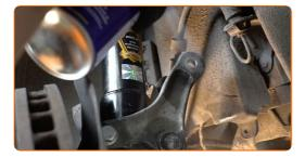
Montieren Sie den Querlenker.
