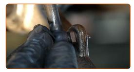
Schrauben Sie die Befestigungen des Sensors der Leuchtweitenregulierung ein. Verwenden Sie Ring-Gabelschlüssel Nr. 10.
