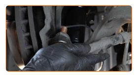
Schrauben Sie die Befestigungsmutter auf, die den Spurstangenkopf mit dem Achsschenkel verbindet. Verwenden Sie Ring-Gabelschlüssel Nr. 21. Verwenden Sie den Torx T40. Verwenden Sie einen Ratschenschlüssel.
