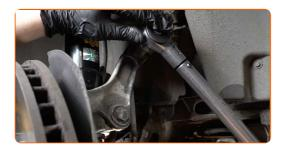
Ziehen Sie die Befestigungsmutter an, die den Spurstangenkopf mit dem Achsschenkel verbindet. Verwenden Sie Stecknuss Nr. 21. Verwenden Sie einen Drehmomentschlüssel. Ziehen Sie ihn mit 165 Nm Drehmoment fest.
