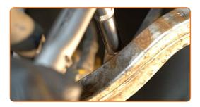
Ziehen Sie das Befestigungselement an, das die Druckstange mit dem Federbein verbindet. Verwenden Sie Stecknuss Nr. 16. Verwenden Sie einen Drehmomentschlüssel. Ziehen Sie ihn mit 65 Nm Drehmoment fest.
