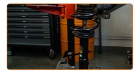
Behandeln Sie den Federbeinbefestigungssitz am Achsschenkel. Benutzen Sie eine Drahtbürste. Benutzen Sie WD-40-Spray.
