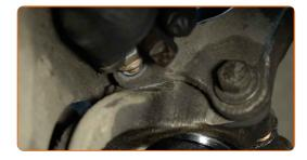
Schrauben Sie das Befestigungselement ein, das das Federbein mit dem Achsschenkel verbindet. Verwenden Sie Stecknuss Nr. 18. Verwenden Sie einen Ratschenschlüssel.
