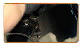
Schrauben Sie die Befestigung der Pendelstützenhalterung ein. Verwenden Sie Stecknuss Nr. 16. Verwenden Sie einen Ratschenschlüssel.
