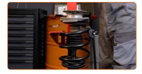
Entfernen Sie das zusammengebaute Federbein.
