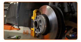
Lösen Sie die Verdrahtung und den Bremsschlauch aus der Halterung am Federbein.
