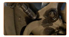
Schrauben Sie das untere Befestigungselement ab, dass das Federbein mit dem Achsschenkel verbindet. Verwenden Sie Ring-Gabelschlüssel Nr. 18. Verwenden Sie Stecknuss Nr. 18. Verwenden Sie einen Ratschenschlüssel.
