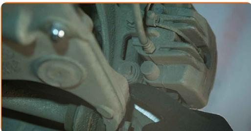
**10** Lösen Sie die Befestigung der Sattelhalterung. Verwenden Sie Stecknuss Nr. 18. Verwenden Sie einen Ratschenschlüssel.
