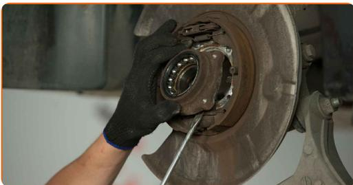
**34** Drücken Sie die Radnabe in den Lagerinnenring. Verwenden Sie einen Druckstücksatz mit Ein-/Auspresswerkzeug. Benutzen Sie einen Hammer.
