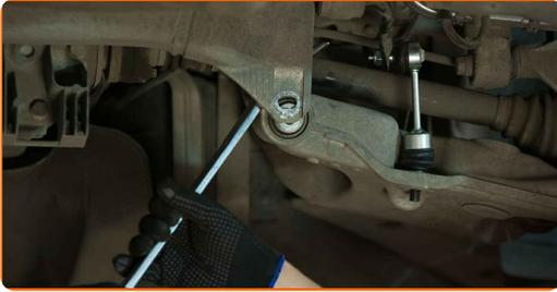
**29** Schrauben Sie die Befestigungsschrauben der Antriebswelle vom Untersetzungsgetriebe ab. Verwenden Sie Stecknuss Nr. E12. Verwenden Sie einen Ratschenschlüssel.
