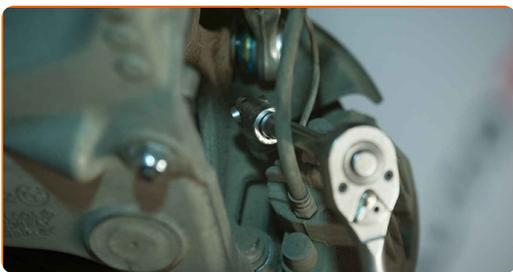
**11** Bauen Sie den Bremssattel inklusive dessen Halterung aus. Verwenden Sie einen flachen Schraubendreher.
