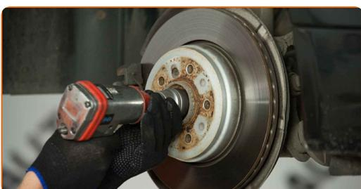
**8** Entfernen Sie die Befestigungsmutter.
