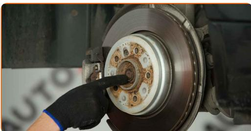
**7** Schrauben Sie die Radnaben-Achsmutter ab. Verwenden Sie Stecknuss Nr. 36. Verwenden Sie einen Ratschenschlüssel.
