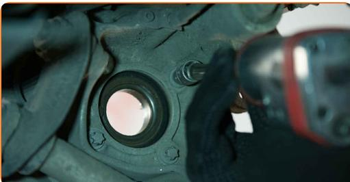
**32** Entfernen Sie die Befestigungsschrauben. Verwenden Sie einen Splintentreiber. Benutzen Sie einen Hammer.
