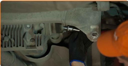
**30** Entfernen Sie die Antriebswelle. Verwenden Sie einen Gummi-Hammer.
