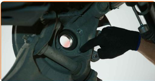
**33** Entfernen Sie die Nabenlagerhalterung. Verwenden Sie einen flachen Schraubendreher.
