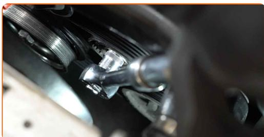
**8** Entfernen Sie den Keilrippenriemen.
