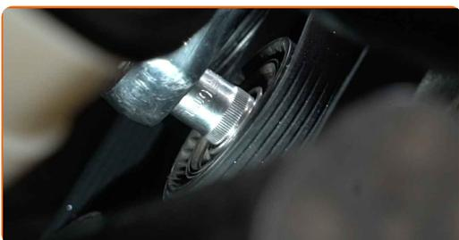
**11** Ziehen Sie die Spannrolle des Klimakompressors beiseite. Verwenden Sie Stecknuss Nr. 13.
