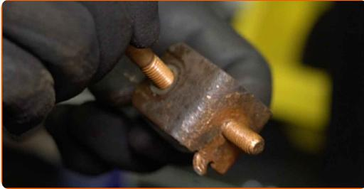
**20** Schrauben Sie die Befestigung der Pendelstützenhalterung ein. Verwenden Sie Stecknuss Nr. 13. Verwenden Sie einen Ratschenschlüssel.
