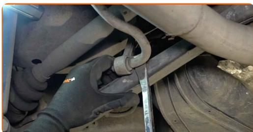
**9** Reinigen Sie alle Gelenke der Koppelstange. Benutzen Sie eine Drahtbürste. Benutzen Sie WD-40-Spray.
