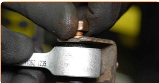
**21** Reinigen Sie die Montagesitze der Koppelstange. Benutzen Sie eine Drahtbürste. Benutzen Sie WD-40-Spray.
