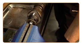
Schrauben Sie die untere Befestigung der Federbeinkolbenstange an. Verwenden Sie Ring-Gabelschlüssel Nr. 17. Benutzen Sie einen Rollgabelschlüssel. Verwenden Sie einen Drehmomentschlüssel. Ziehen Sie ihn mit 20 Nm Drehmoment fest.
