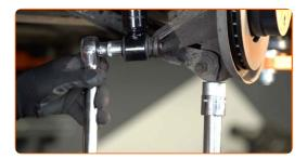
Entfernen Sie den Träger unter dem Arm.
