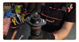
Greifen Sie den Stoßdämpfer mit einem Schraubstock.
