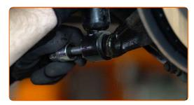
Schrauben Sie das obere Befestigungselement des Stoßdämpfers ab. Verwenden Sie Stecknuss Nr. 13. Verwenden Sie einen Ratschenschlüssel.
