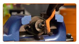
Entfernen Sie die Befestigung der Stoßdämpferkolbenstange. Verwenden Sie Ring-Gabelschlüssel Nr. 17.
