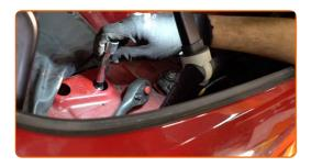
Ziehen Sie den unteren Befestiger des Stoßdämpfers an. Verwenden Sie Stecknuss Nr. 18. Verwenden Sie einen Drehmomentschlüssel. Ziehen Sie ihn mit 100 Nm Drehmoment fest.
