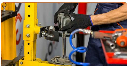
36 Entnehmen Sie den alten Stoßdämpfer aus dem hydraulischen Spiralfederspanner.
