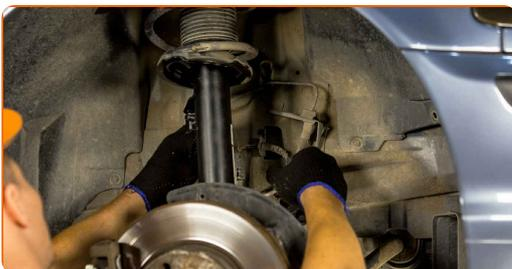
64 Entfernen Sie den Träger unter dem Arm.
