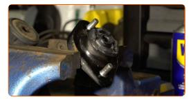
Entfernen Sie die Staubmanschette und den Anschlagpuffer des Stoßdämpfers.
