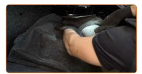
Bringen Sie die Clips der Seitenauskleidung des Kofferraums an.
