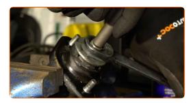
Entfernen Sie den oberen Halter des Stoßdämpfers.
