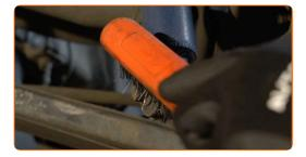
Schrauben Sie den unteren Befestiger des Stoßdämpfers ab. Verwenden Sie Stecknuss Nr. 17. Verwenden Sie einen Ratschenschlüssel.
