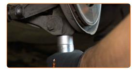
Ziehen Sie den unteren Befestiger des Stoßdämpfers an. Verwenden Sie Stecknuss Nr. 17. Verwenden Sie einen Drehmomentschlüssel. Ziehen Sie ihn mit 100 Nm Drehmoment fest.
