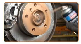
Die Bremsscheibenoberfläche reinigen. Benutzen Sie einen Bremsenreiniger.
