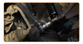
Entfernen Sie den Träger unter dem Arm.
