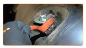
Drehen Sie das obere Befestigungselement des Stoßdämpfers auf. Verwenden Sie Stecknuss Nr. 13. Verwenden Sie einen Ratschenschlüssel.
