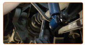
Den Stoßdämpfer entfernen.
