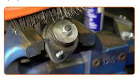
Entfernen Sie die Befestigung der Stoßdämpferkolbenstange. Verwenden Sie einen Stoßdämpfer Steckschlüsseleinsatz DDNº6. Verwenden Sie Stecknuss Nr. 16. Verwenden Sie einen Ratschenschlüssel.
