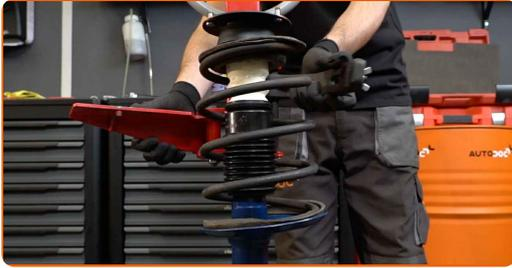
**37** Entfernen Sie das zusammengebaute Federbein.
