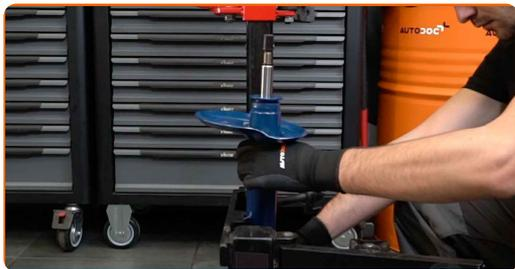
**29** Installieren Sie die Feder am Stoßdämpfer.
