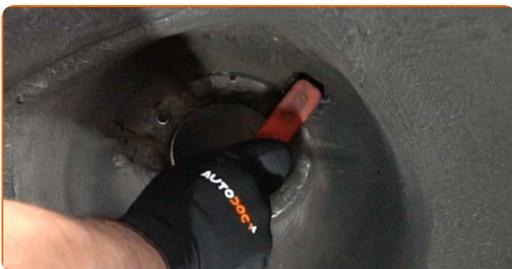
**39** Installieren Sie das Federbein am Radlauf.
