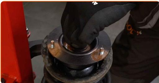
**36** Dekomprimieren Sie die Feder.
