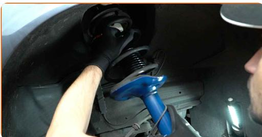
**40** Sichern Sie die oberen Befestigungen des Federbeines. Schrauben Sie diese nicht fest.
