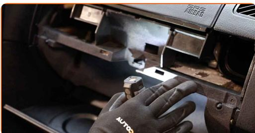
**21** Schrauben Sie die Befestigungsschrauben des Handschuhfaches fest. Verwenden Sie einen Kreuzschlitzschraubendreher.
