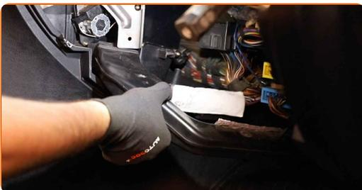
**17** Bringen Sie die Befestigungen des Luftkanal-Gehäuses an.
