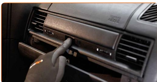
**3** Lösen Sie die Befestigungsschrauben des Handschuhfaches ab. Verwenden Sie einen Kreuzschlitzschraubendreher. Verwenden Sie einen flachen Schraubendreher.
