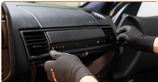
**24** Schrauben Sie die Befestigungsschrauben des Handschuhfaches fest. Verwenden Sie einen Kreuzschlitzschraubendreher.
