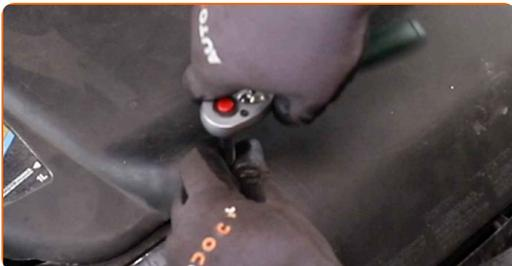
**4** Entferne die Komponenten des Lüftungskanals.
