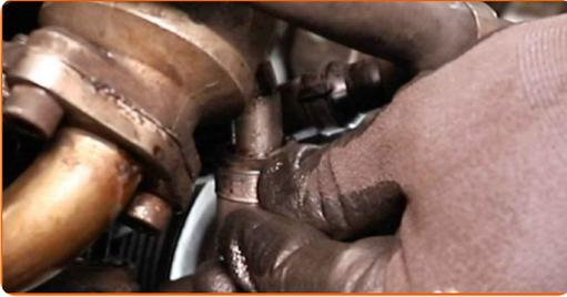
52 Sichern Sie die Klemme des Kühlmittelschlauchs. Verwenden Sie Stecknuss Nr. 7. Verwenden Sie einen Ratschenschlüssel.
