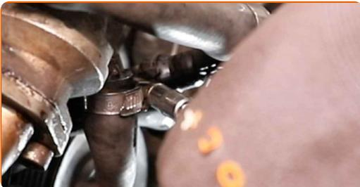
53 Bringen Sie den Kühlmittelschlauch an.
