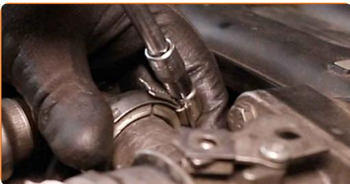
51 Bringen Sie den Kühlmittelschlauch an.
