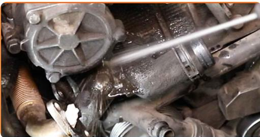
32 Schrauben Sie die Befestigungselemente des Thermostatgehäuses ab. Verwenden Sie Stecknuss Nr. 10. Verwenden Sie einen Ratschenschlüssel.
