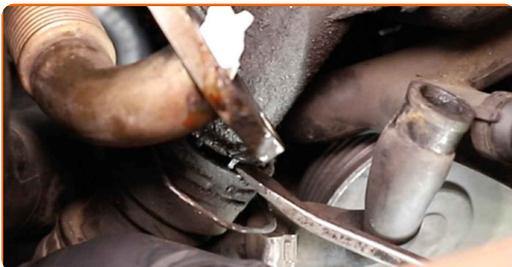
30 Lösen Sie den Kühlmittelschlauch.
