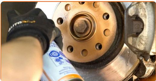
**26** Die Bremsscheibenoberfläche reinigen. Benutzen Sie einen Bremsenreiniger.
