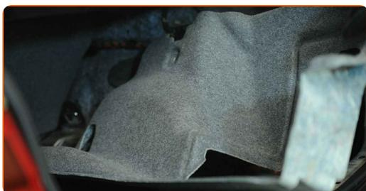
**22** Entfernen Sie die Schutzkappe der Stoßdämpferhalterung. Verwenden Sie einen flachen Schraubendreher.
