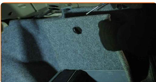
**19** Entfernen Sie die Clips der Seitenauskleidung des Kofferraums. Verwenden Sie einen flachen Schraubendreher.
