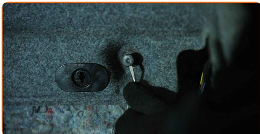
**20** Schrauben Sie das Befestigungselement der Seitenauskleidung des Kofferraums heraus. Verwenden Sie den Torx T25. Verwenden Sie einen Ratschenschlüssel.
