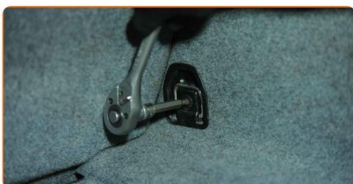
**21** Entfernen Sie die Seitenauskleidung des Kofferraums.
