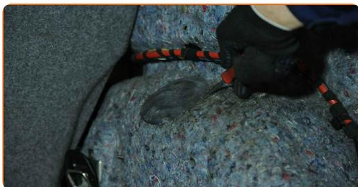
**23** Reinigen Sie die Befestigungselemente des Stoßdämpferdomlagers. Benutzen Sie eine Drahtbürste. Benutzen Sie WD-40-Spray.
