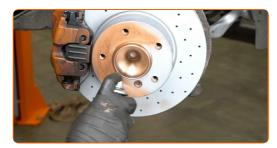
Die Bremsscheibenoberfläche reinigen. Benutzen Sie einen Bremsenreiniger.
