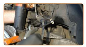
Verbinden Sie den Stecker des Verschleißseonsors der Bremsbeläge.
