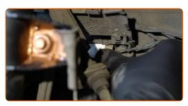
Bauen Sie den Verschleißsensor auf den Bremsbelägen ein.
