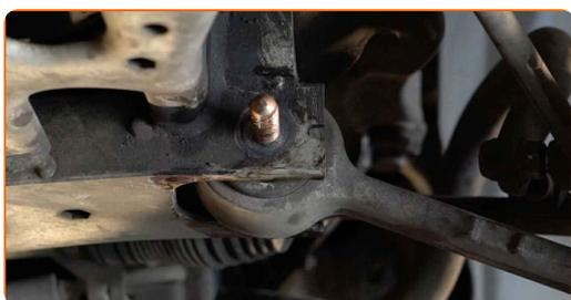
**58** Reinigen Sie die Montagesitze des Spurstangenkopfes. Benutzen Sie eine Drahtbürste. Benutzen Sie WD-40-Spray.
