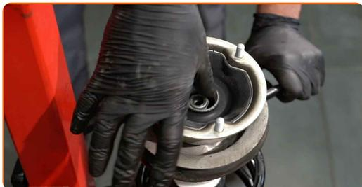
**43** Ziehen Sie die Federbeinkolbenstangenmutter an. Verwenden Sie Stecknuss Nr. 21. Verwenden Sie Inbusschlüssel Nr. H6. Verwenden Sie einen Drehmomentschlüssel. Ziehen Sie ihn mit 64 Nm Drehmoment fest.
