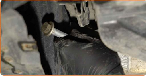
**28** Entfernen Sie die Querlenker. Benutzen Sie ein Brecheisen.
