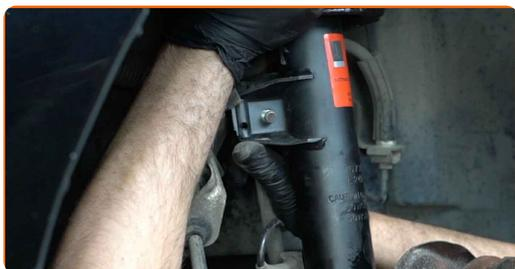
**73** Ziehen Sie das Befestigungselement an, das die Druckstange mit dem Federbein verbindet. Verwenden Sie Ring-Gabelschlüssel Nr. 18. Verwenden Sie Stecknuss Nr. 15. Verwenden Sie einen Drehmomentschlüssel. Ziehen Sie ihn mit 58 Nm Drehmoment fest.
