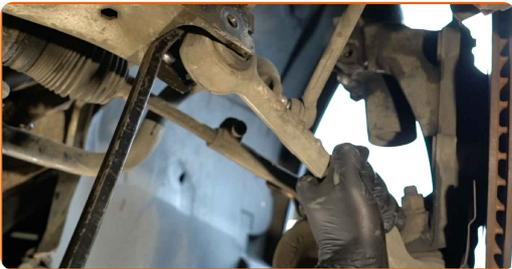
**29** Entfernen Sie die Befestigungsschraube.
