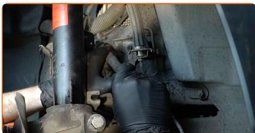
**71** Verbinden Sie das ABS mit der Sensorverdrahtung.
