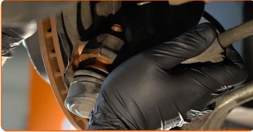
**60** Schrauben Sie die Befestigungsmutter auf, die den Spurstangenkopf mit dem Achsschenkel verbindet. Verwenden Sie Stecknuss Nr. 21. Verwenden Sie einen Ratschenschlüssel.
