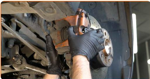
**62** Befestigen Sie die Bremssattelhalterung. Verwenden Sie Stecknuss Nr. 18. Verwenden Sie einen Drehmomentschlüssel. Ziehen Sie ihn mit 110 Nm Drehmoment fest.
