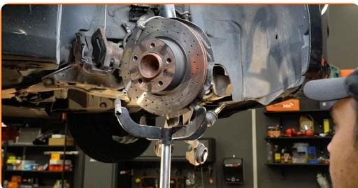
**31** Lösen Sie das untere Befestigungselement, dass das Federbein mit dem Achsschenkel verbindet. Verwenden Sie eine spezielle Schraubnuss, um den Stoßdämpfer zu entfernen. Verwenden Sie einen Ratschenschlüssel.
