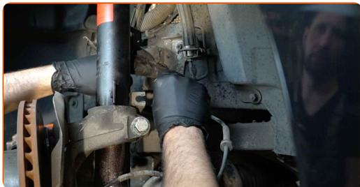
**72** Montieren Sie den Querlenker.
