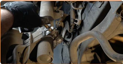
**30** Stützen Sie die Achsschenkel auf. Benutzen Sie einen hydraulischen Getriebeheber.
