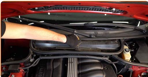
**4.1** Heben Sie die Abdeckung des Innenraumfilter-Gehäuses leicht an.
