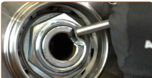
**26** Installieren Sie die Schutzkappe des Nabenlagers. Verwenden Sie einen Druckstücksatz mit Ein-/Auspresswerkzeug. Benutzen Sie einen Hammer.
