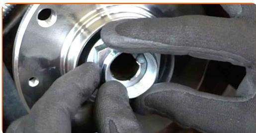
**24** Ziehen Sie die Nabenbefestigung fest. Verwenden Sie Stecknuss Nr. 41. Verwenden Sie einen Drehmomentschlüssel. Ziehen Sie ihn mit 275 Nm Drehmoment fest.
