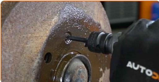
**8** Entfernen Sie die Befestigungsschrauben.
