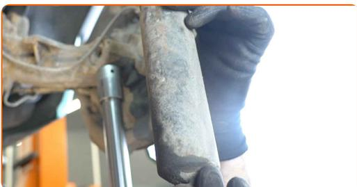
**12** Reinigen Sie die Stoßdämpferaufnahmen. Benutzen Sie eine Drahtbürste. Benutzen Sie WD-40-Spray.
