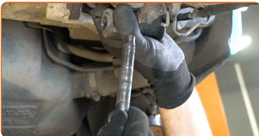
**11** Den Stoßdämpfer entfernen.
