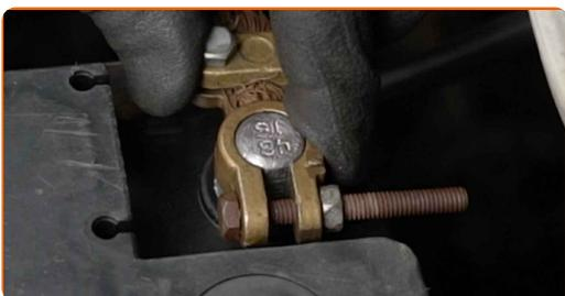
**26** Schrauben Sie die Befestigung der negative Klemme der Batterie an. Verwenden Sie Ring-Gabelschlüssel Nr. 10.
