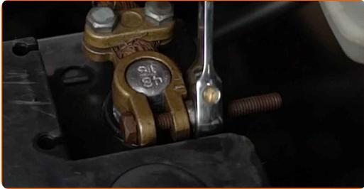
**6** Trennen Sie die Erdungskabelklemme von der Batterie.
