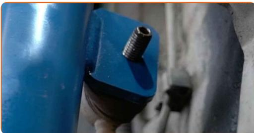
**73** Ziehen Sie das Befestigungselement an, das die Druckstange mit dem Federbein verbindet. Verwenden Sie Ring-Gabelschlüssel Nr. 17. Verwenden Sie einen Drehmomentschlüssel. Ziehen Sie ihn mit 40 Nm Drehmoment fest.
