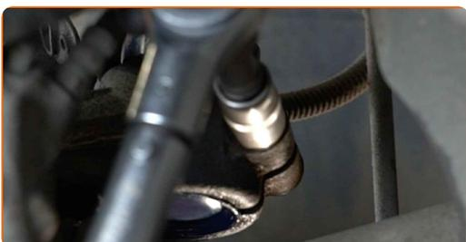
**71** Reinigen Sie die Befestigung der Koppelstange. Benutzen Sie eine Drahtbürste. Benutzen Sie WD-40-Spray.
