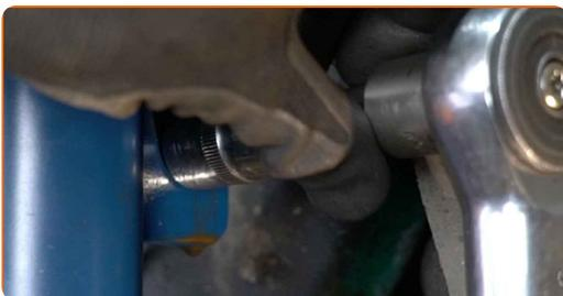
**74** Installieren Sie die Halterung des Bremsschlauchs.
