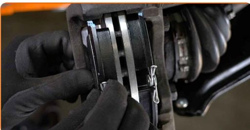
**33** Installieren Sie den Bremssattel und fixieren Sie diesen.
