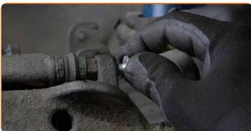
**35** Ziehen Sie die Bremssattelbefestigungen fest. Verwenden Sie Ring-Gabelschlüssel Nr. 13. Verwenden Sie Ring-Gabelschlüssel Nr. 15. Verwenden Sie einen Drehmomentschlüssel. Ziehen Sie ihn mit 27 Nm Drehmoment fest.
