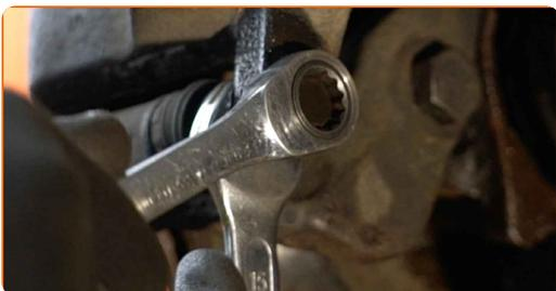
**10** Entfernen Sie die Befestigungsschrauben.
