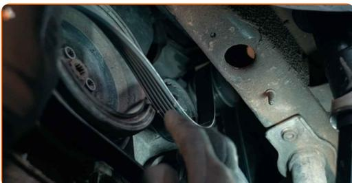
Austausch: Keilriemen – VW Passat B7 Limousine. Tipp:
