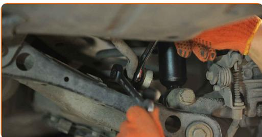
**8** Entfernen Sie die Befestigungsschraube.
