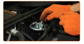
Ziehen Sie die Befestigungsklemme der Kraftstofffilterleitung an. Verwenden Sie Zangen.
