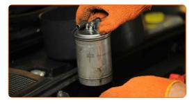
10 Installieren Sie einen neuen Kraftstofffilter.
