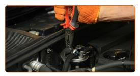
Lösen Sie die Schläuche vom Kraftstofffilter. Verwenden Sie einen flachen Schraubendreher.
