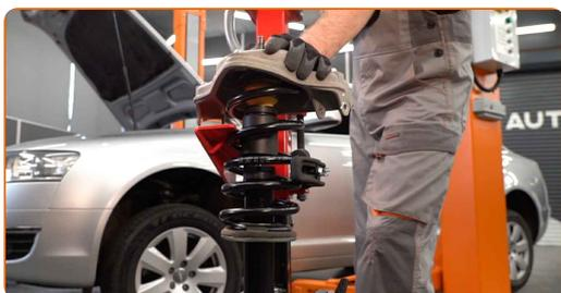
**39** Ziehen Sie die Federbeinkolbenstangenmutter an. Verwenden Sie Stecknuss Nr. 18. Verwenden Sie einen Ratschenschlüssel. Verwenden Sie einen Drehmomentschlüssel. Ziehen Sie ihn mit 50 Nm Drehmoment fest.
