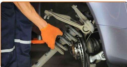
**21** Stellen Sie das Dämpferbein auf das Federspannwerkzeug.
