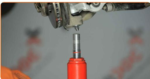
**57** Ziehen Sie die untere Befestigung des Stoßdämpfers an. Verwenden Sie Ring-Gabelschlüssel Nr. 18. Verwenden Sie Stecknuss Nr. 18. Verwenden Sie einen Drehmomentschlüssel. Ziehen Sie ihn mit 90 Nm Drehmoment fest.
