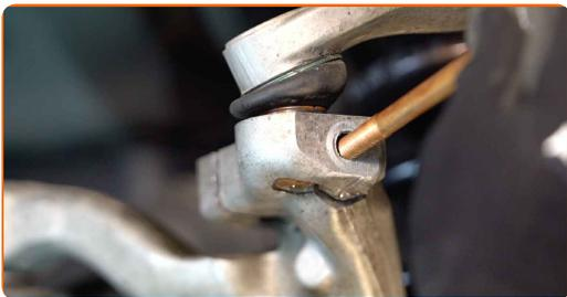
**55** Ziehen Sie die Befestigung des oberen Arms an. Verwenden Sie Ring-Gabelschlüssel Nr. 16. Verwenden Sie Stecknuss Nr. 16. Verwenden Sie einen Drehmomentschlüssel. Ziehen Sie ihn mit 40 Nm Drehmoment fest.
