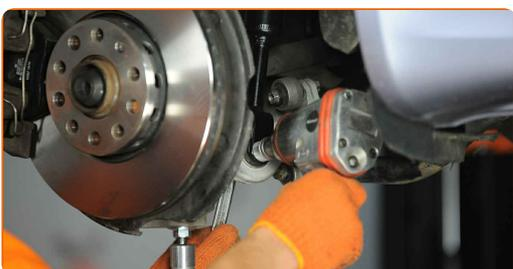
**58** Entfernen Sie den Träger unter dem Achsschenkel.
