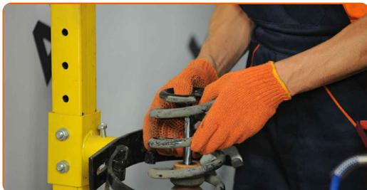
**37** Montieren Sie die obere Stoßdämpferhalterung, die mit den Querlenkern zusammengebaut ist.
