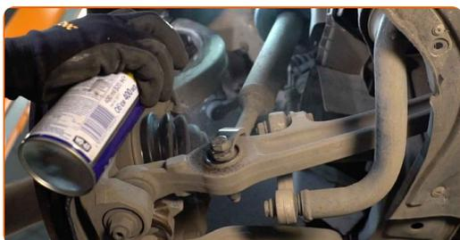
**7** Untere Befestigung der Stoßdämpferfedern abschrauben. Verwenden Sie Ring-Gabelschlüssel Nr. 18. Verwenden Sie Stecknuss Nr. 18. Verwenden Sie einen Ratschenschlüssel.
