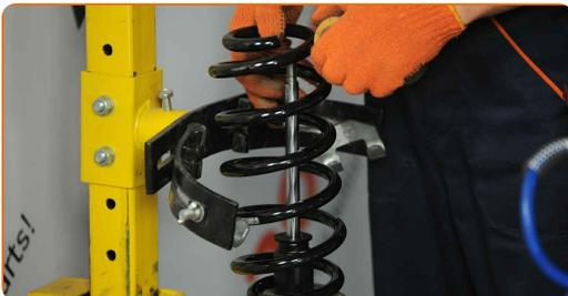
**30** Installieren Sie die Manschette und eine Stoßstopp auf den Stoßdämpfer.
