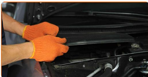
**18** Entfernen Sie die Schutzkappe der Stoßdämpferhalterung. Verwenden Sie einen flachen Schraubendreher.
