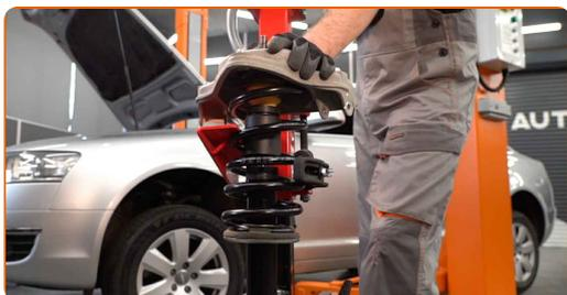
**33** Ziehen Sie die Federbeinkolbenstangenmutter an. Verwenden Sie Stecknuss Nr. 19. Verwenden Sie einen Ratschenschlüssel. Verwenden Sie einen Drehmomentschlüssel. Ziehen Sie ihn mit 50 Nm Drehmoment fest.
