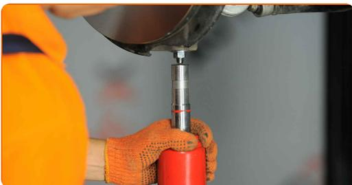
**51** Ziehen Sie die untere Befestigung des Stoßdämpfers an. Verwenden Sie Ring-Gabelschlüssel Nr. 18. Verwenden Sie Stecknuss Nr. 18. Verwenden Sie einen Drehmomentschlüssel. Ziehen Sie ihn mit 90 Nm Drehmoment fest.
