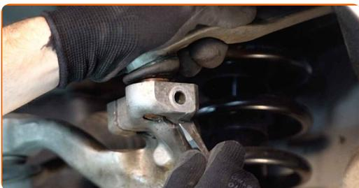
**48** Bringen Sie die Befestigungsschraube an. Benutzen Sie einen Hammer. Verwenden Sie einen Splintentreiber.
