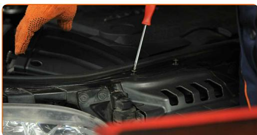
**19** Bringen Sie das Luftkanal-Gehäuse an.
