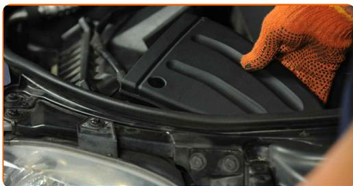
**18** Sichern Sie das Befestigungselement des Luftansaugkanals. Verwenden Sie einen Kreuzschlitzschraubendreher.
