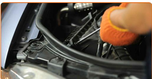
**9** Heben Sie die Abdeckung des Luftfiltergehäuses leicht an.
