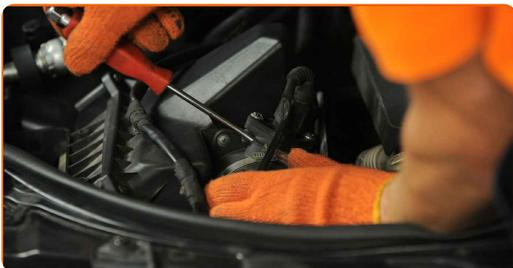
**17** Bringen Sie das Luftkanal-Gehäuse an.
