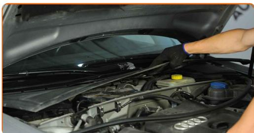
**18** Entfernen Sie die Kappe des Federbeinstützlagers. Verwenden Sie einen flachen Schraubendreher.
