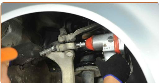
**51** Stützen Sie die Achsschenkel auf. Benutzen Sie einen hydraulischen Getriebeheber.
