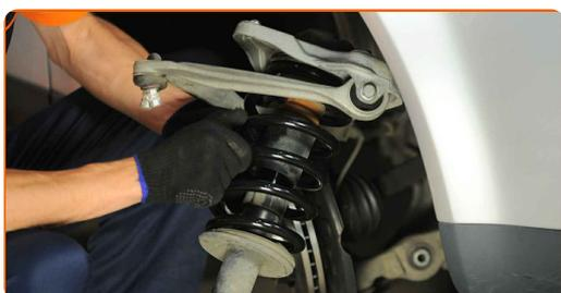
**38** Schrauben Sie die obere Befestigung des Domlagers an.
