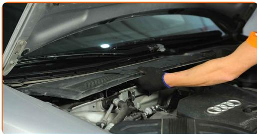
**43** Bauen Sie die Dichtung der Windabweiserabdeckung ein.
