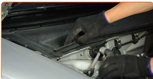
**44** Entfernen Sie die Kotflügel-Abdeckung.
