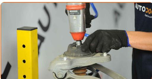
**26** Entfernen Sie die obere Halterung, die Stützlager und den oberen Federteller.
