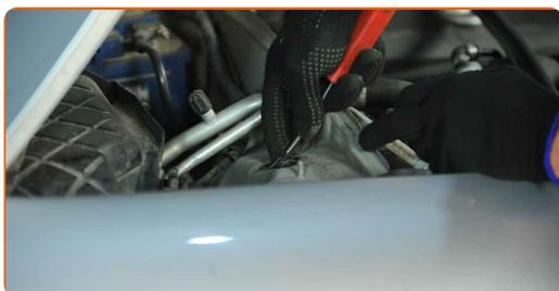
**19** Reinigen Sie die Befestigungselemente der oberen Federbeinhalterung. Benutzen Sie eine Drahtbürste. Benutzen Sie Sie WD-40-Spray.
