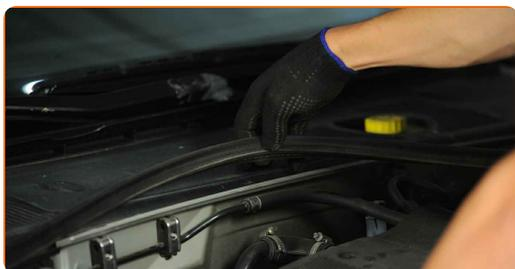
**17** Heben Sie die Windabweiserabdeckung an und entfernen Sie dieses.
