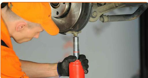
**52** Ziehen Sie die unteren Befestigungen an, die das Federbein mit dem Achsschenkel verbinden. Verwenden Sie Ring-Gabelschlüssel Nr. 18. Verwenden Sie Stecknuss Nr. 18. Verwenden Sie einen Drehmomentschlüssel. Ziehen Sie ihn mit 90 Nm Drehmoment fest.
