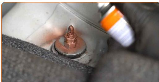
**35** Installieren Sie die Schutzkappe des Stoßdämpfers.
