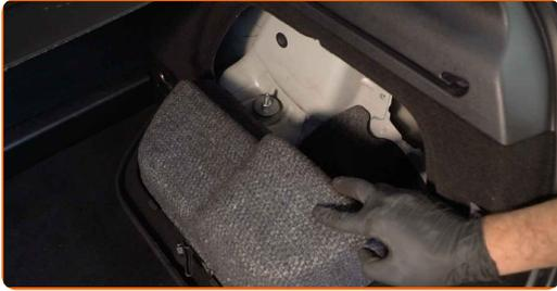
**5** Lockern Sie das obere Befestigungsgelelement des Stoßdämpfers. Verwenden Sie Stecknuss Nr. 16. Verwenden Sie einen Stoßdämpfer Steckschlüsseleinsatz DD Nr. 6. Verwenden Sie einen Ratschenschlüssel.
