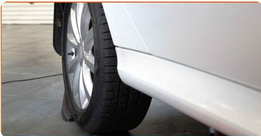
**7** Lösen Sie die Radhalterungsschrauben. Verwenden Sie eine Schlagnuss für Felgen # H12.
