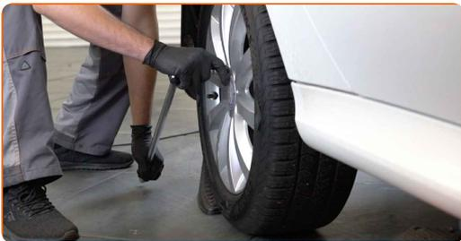
**8** Heben Sie die Rückseite des Autos und sichern auf Stützen.
