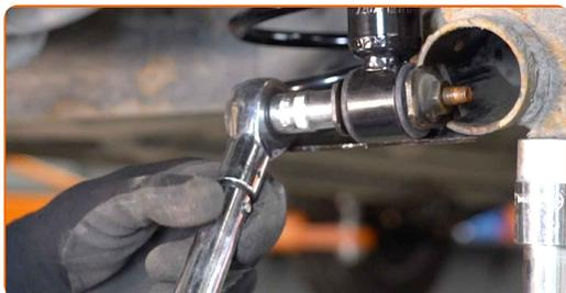
19 Die Montage unter dem Hinterachsträger entfernen.
