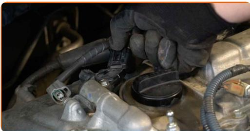
**5** Reinigen Sie die Zündspulen.
