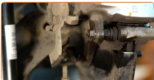
**9** Schrauben Sie die Befestigung des Bremssattels ab. Verwenden Sie Ring-Gabelschlüssel Nr. 14. Verwenden Sie Ring-Gabelschlüssel Nr. 17.
