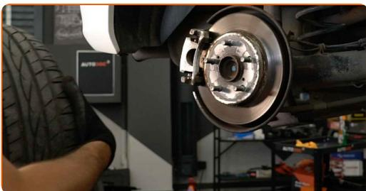
**7** Die Bremssattelbefestigungen reinigen. Benutzen Sie eine Drahtbürste. Benutzen Sie WD-40-Spray.
