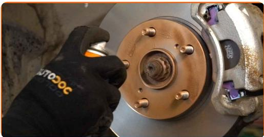
**50** Die Bremsscheibenoberfläche reinigen. Benutzen Sie einen Bremsenreiniger.
