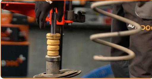
**29** Installieren Sie die Feder am Stoßdämpfer.
