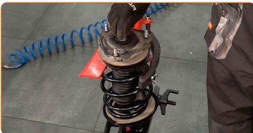
**32** Ziehen Sie die Federbeinkolbenstangenmutter an. Verwenden Sie einen Kettenschlüssel. Verwenden Sie Stecknuss Nr. 21. Verwenden Sie einen Drehmomentschlüssel. Ziehen Sie ihn mit 47 Nm Drehmoment fest.
