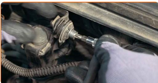
**6** Schrauben Sie die Kappe des Bremsflüssigkeitsausgleichsbehälters ab.
