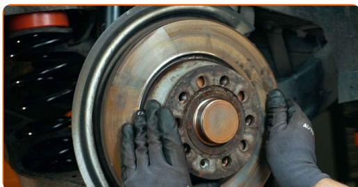
**31** Ziehen Sie die Befestigung der Bremsscheibe fest. Verwenden Sie den Torx T30. Verwenden Sie einen Drehmomentschlüssel. Ziehen Sie ihn mit 4 Nm Drehmoment fest.
