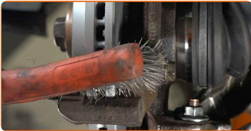
15 Behandeln Sie die Bremsbeläge in dem Bereich, wo ihre Oberfläche mit dem Bremssattelhalter in Berührung tritt. Benutzen Sie eine Anti-Quietsch-Paste.
