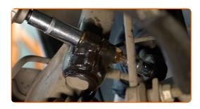
Entfernen Sie die Befestigungsschraube.
