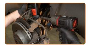
Montieren Sie den Querlenker.
