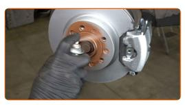
Die Bremsscheibenoberfläche reinigen. Benutzen Sie einen Bremsenreiniger.
