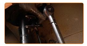
Ziehen Sie das Kugelgelenk an. Verwenden Sie Stecknuss Nr. 16. Verwenden Sie einen Drehmomentschlüssel. Ziehen Sie ihn mit 60 Nm Drehmoment fest.
