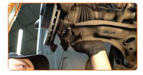
Schrauben Sie die Befestigungen des Kugelgelenks ein. Verwenden Sie Stecknuss Nr. 16. Verwenden Sie einen Ratschenschlüssel.
