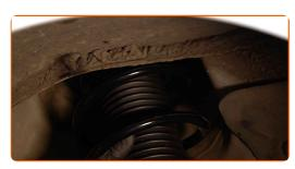
Schrauben Sie die obere Befestigung des Domlagers an. Schrauben Sie diese nicht fest.
