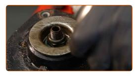
Entfernen Sie die Stangenmutter des Federkolben. Verwenden Sie Inbusschlüssel Nr. H7. Verwenden Sie Stecknuss Nr. 21. Verwenden Sie einen Ratschenschlüssel.
