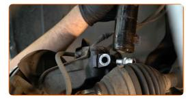
Lösen Sie die obere Befestigung des Domlagers.
