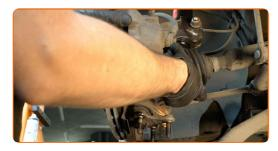
Verbinden Sie das Kugelgelenk mit dem Lenker.
