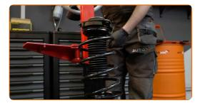
Entfernen Sie das zusammengebaute Federbein.
