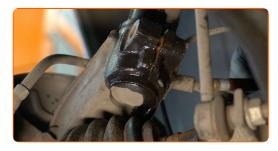
Lösen Sie das Befestigungselement, welches die Antriebswelle mit der Radnabe verbindet. Verwenden Sie Stecknuss Nr. 24. Verwenden Sie einen Ratschenschlüssel.
