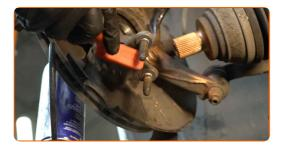
Entfernen Sie den Träger unter dem Achsschenkel.
