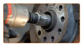
20 Entfernen Sie die Befestigungsschraube.
