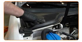
Bauen Sie die Dichtung der Windabweiserabdeckung ein.
