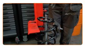
Montieren Sie die Befestigung, die Manschette und den Stoßstopp am neuen Stoßdämpfer.
